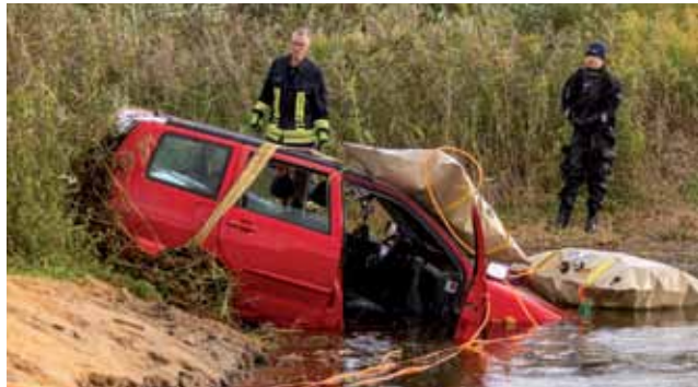
Hebekissen im Einsatz am Autowrack
